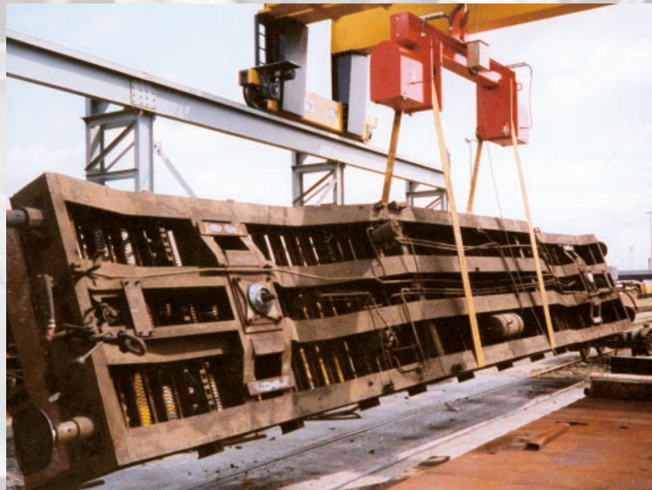
ROTOMAX® VARIO 20 000 beim Drehen von Fahrgestellen ROTOMAX® VARIO 20 000 rotating railway wagons for EWS Railways ROTOMAX® VARIO 20 000 pour le retournement de chassis
