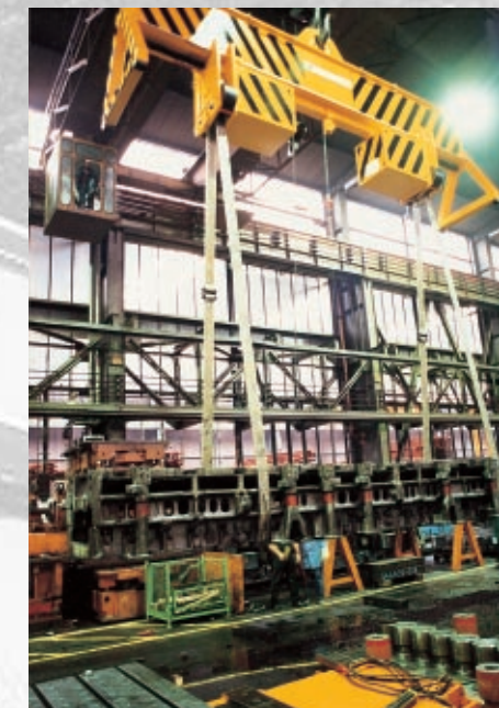
ROTOMAX® 10 000 beim Drehen eines Verzinkungskessels ROTOMAX® 10 000 turning of a galvanizing bath ROTOMAX® 10 000 lors du retournement d'une cuve de galvanisation
