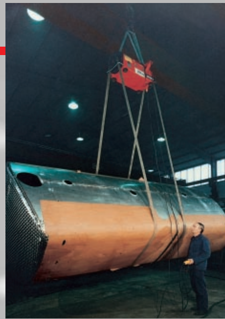
ROTOMAX® 5 000 im Tankkesselbau ROTOMAX® 5 000 rotating boiler ROTOMAX® 5 000 pour la fabrication de citernes
