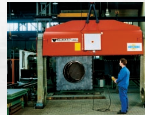
ROTOMAX® mit Infrarotsteuerung in der Betonfertigteileindustrie ROTOMAX® radio controlled to rotate concrete floors ROTOMAX® avec commande infra rouge dans l'industrie du béton
