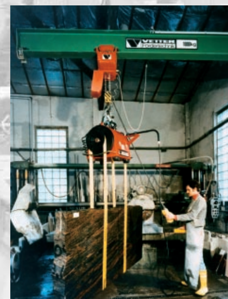
Wenden eines gehefteten Kastenträgers Turning of a box girder Retournement d'une pièce usinée lourde
